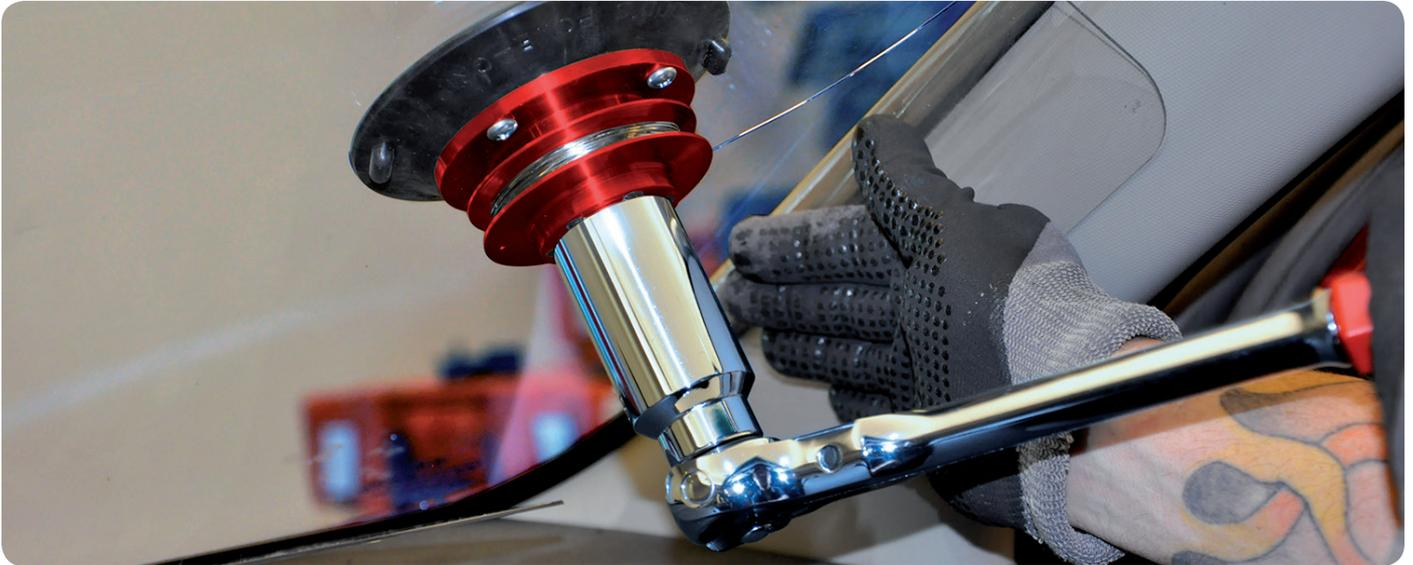
Das Draht-Austrennsystem Equalizer® Viper™ wurde für den Austausch kleiner Seitenscheiben entworfen, eignet sich aber auch zum Austrennen von Front- und Heckscheiben. Es ist klein, leicht und einfach zu handhaben.
