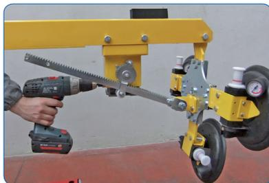
■ **SL-350-ZS1 Schwenkvorrichtung für Scheiben-Lift**
