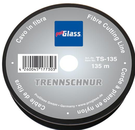
Spezielschnur aus hochfesten, geflochtenen Polyethylen-Fasern. Dank des sehr geringen Durchmessers von nur 0,5 mm kann diese Trennschnur von Hand (Achtung: Zugriffe TSG oder DGL-201TS verwenden!) gezogen werden. Aber auch mit dem SPIDER kann die Schnur eingesetzt werden um z. B. sehr tief auf dem Karosserieflansch liegende Scheiben auszutrennen.
