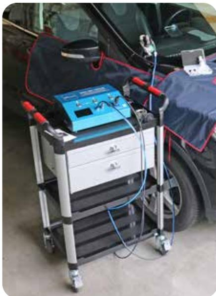
Durch die Kombination des Reparatursystems WSR-800 GECKO mit dem Werkstattwagen WSW-800 erhalten Sie einen stets einsatzbereiten Arbeitsplatz für die Steinschlagreparatur. Der GECKO steht auf der oberen Ablage in einer angenehmen Arbeitshöhe, das Verbrauchsmaterial und die Komponenten finden ihren Platz in den abschließbaren Schubladen. Die beiden darunter liegenden Plattformen bieten großzügige Ablagemöglichkeiten für Putzpapier, Scheibenreiniger, Fahrzeugschoner, usw.
