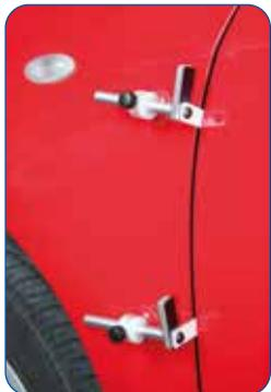
Zu einer fachgerechten Scheibenmontage nach Herstellervorgabe gehört die genaue Einhaltung der Abstände vom Scheibenrand zur Karosserie. Da geklebte Scheiben nach dem Einsetzen nur noch wenig bewegt werden dürfen ist es sinnvoll, die korrekten Abstände bereits während des Einsetzens sicherzustellen.
