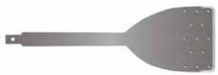
Bei den Express® HydroBlade Klingen wurden auf der dem Glas abgewandten Seite eine Reihe runder Vertiefungen eingestanz. Diese Vertiefungen sind so geformt, dass sie das Schneideschmiermittel in die Kleberaube transportieren. Das Schmiermittel lässt die Klinge mit jedem Hub leichter in die Kleberaube gleiten. Abgesehen vom leichteren Schneidevorgang führt die niedrigere Reibung der Klinge auch zu einem geringeren Batterieverbrauch und reduziert die Vibrationen des Gerätes.
