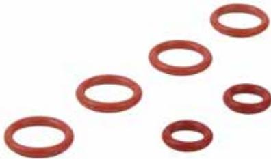
Das Set enthält jeweils 2 Dichtungen für den Harztank (Ø 11,6 mm), die Harzkammer (Ø 7,5 mm) und den Injektor (Ø 11,6 mm). Das Material (MVQ - Silikonkautschuk) weist eine gute Chemikalienresistenz auf. Das heißt, die Dichtungen behalten trotz des regelmäßigen, direkten Kontakts mit dem Reparaturharz ihre Form. Wir empfehlen dennoch den Ersatz aller drei Dichtungen nach 6 Monaten, da sich bei der Benutzung ein gewisser Verschleiß/Abrieb ergibt.
