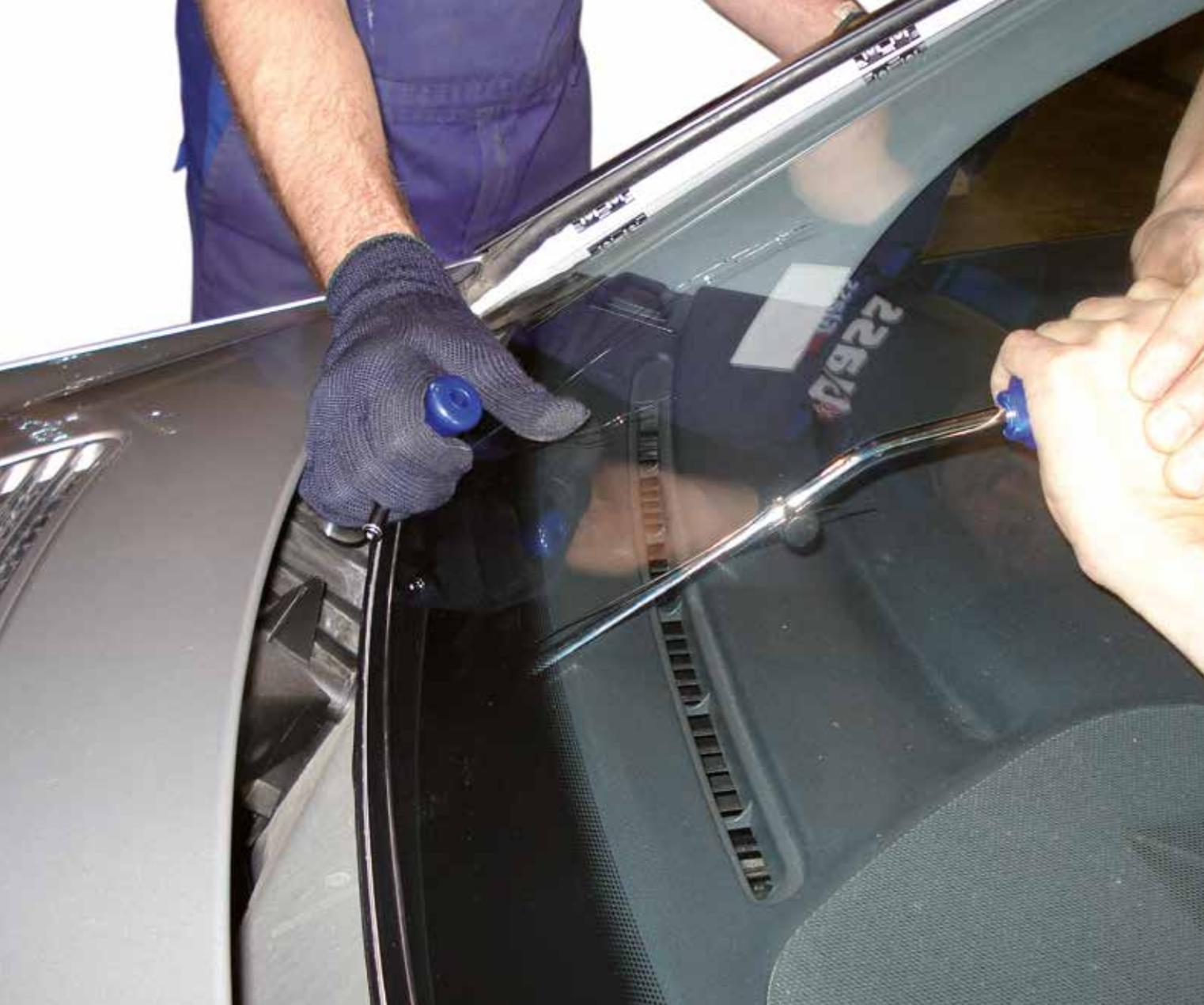
Bei der Einführung im Jahr 2012 hatte der SPIDER von WRD Glass Tools den Markt der Austrennsysteme revolutioniert! Das patentierte Austrenngerät ermöglichte als erstes Gerät seiner Art das **völlig beschädigungsfreie Austrennen geklebter Fahrzeugscheiben**. Zum Durchtrennen der Kleberaupe dient eine speziell entwickelte, extrem belastbare Trennschnur aus Kunststoff. Das schont nicht nur die Karosserie und die Anbauteile, sondern ermöglicht gleichzeitig ein sehr schnelles Arbeiten.
