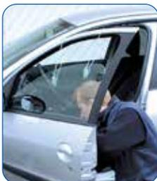
Zum Fixieren der Seitenscheibe bei Arbeiten am Fensterheber, damit Sie stets beide Hände frei haben. Ebenso ideal zum Sichern frisch eingeklebter Windschutzscheiben gegen Abrutschen (ein Ende auf die Scheibe, das Andere aufs Fahrzeugdach).
