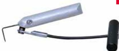
UltraWiz Ziehmesser aus Aluminiumguss mit ergonomischem Griffprofil. Durch die seitliche Klemmschraube kann die Klinge schnell gewechselt und, je nach Bedarf, in unterschiedlichen Positionen fixiert werden. Lieferung inklusive 1 Ziehklinge 25 mm lang.
