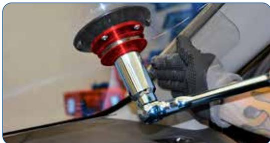
Das Draht-Austrennsystem Equalizer® Viper™ wurde für den Austausch kleiner Seitenscheiben entworfen, eignet sich aber auch zum Austrennen von Front- und Heckscheiben. Es ist klein, leicht und einfach zu handhaben. Bedient wird das Gerät manuell mittels der im Satz enthaltenen Ratsche. Die Drahtspule kann in beide Richtungen betätigt werden und die im Schaft eingebauten Magnete stellen sicher, dass die Ratsche in jeder Situation fest mit dem Werkzeug verbunden bleibt.
