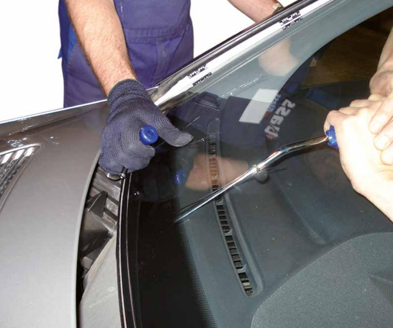
Bei der Einführung im Jahr 2012 hatte der SPIDER von WRD Glass Tools den Markt der Austrennsysteme revolutioniert! Auch die mittlerweile dritte Generation des patentierten Austrenngerätes ermöglicht das völlig beschädigungsfreie Austrennen geklebter Fahrzeugscheiben. Zum Durchtrennen der Kleberaube dient eine speziell entwickelte, extrem belastbare Trennschnur aus Kunststoff. Das schont nicht nur die Karosserie und die Anbauteile, sondern ermöglicht gleichzeitig ein sehr schnelles Arbeiten.
