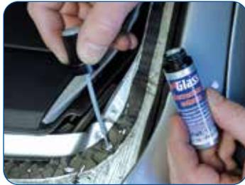
Reparaturstift für die kleinflächige Ausbesserung von Lackschäden am Karosseriefalz. Mit dem im Deckel integrierten Pinsel wird der graue Korrosionsschutz sauber aufgetragen. Das Produkt lüftet sehr schnell ab und benötigt keinen Decklack. Das heißt nach dem Trocknen kann direkt mit dem Scheibeneinbau fortgefahren werden.
