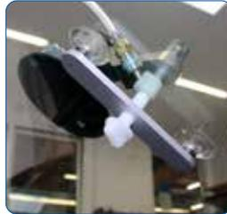
Die Druckbrücke ermöglicht das Erzeugen eines konstanten und kontrollierten Gegendrucks von der Innenseite der Windschutzscheibe. Dies kann das Reparaturergebnis bei z. B. längeren Rissen sehr positiv beeinflussen. Eine sehr sinnvolle Erweiterung für jedes Verbundglas-Reparatursystem. Auch zum Fixieren von frisch aufgeklebten Spiegelfüßen oder Sensoroptiken ist die Druckbrücke hervorragend geeignet.
