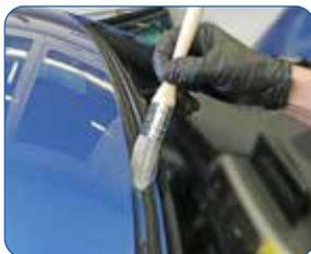
Ein sauberer Karosseriefalz ist die Basis einer ordentlich verklebten und dichten Scheibe. Für das Reinigen des Falzes von leichten Verschmutzungen ist aber nicht immer ein Staubsauger erforderlich. Oft genügt zum Reinigen ein Pinsel mit dem der Schmutz vor dem Zurückschneiden der Restraupe aus den Spalten gebürstet werden kann. Die Kunstfaserhaare dieses Pinsel sind sanft zum Lack und gleichzeitig steif genug zum gründlichen Entfernen des Schmutzes.
