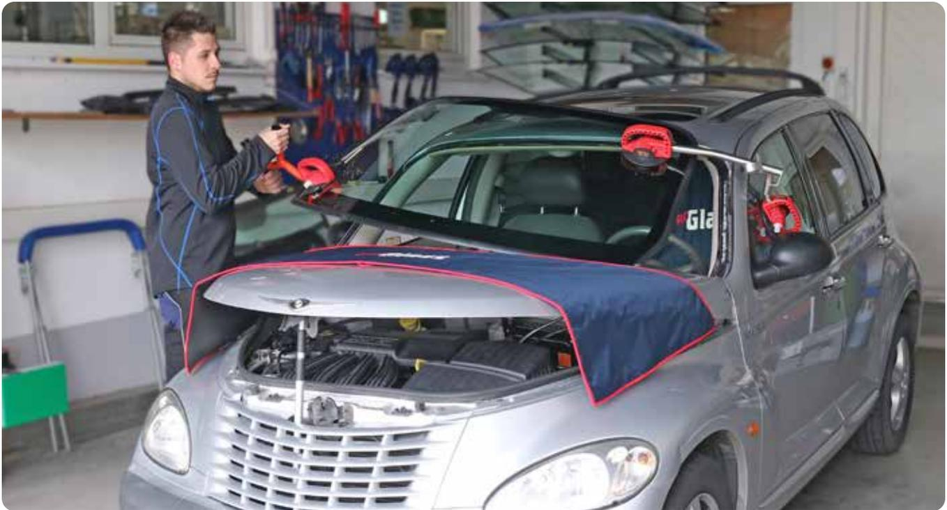
Das Montagesystem aus der PRO6 Serie von WRD Glass Tools ermöglicht das einfache Einsetzen von Windschutzscheiben durch nur eine Person. Das ausgeklügelte System eignet sich für Pkw- und Transporterscheiben und gestattet die Windschutzscheiben-Montage an nahezu sämtlichen Fahrzeugmodellen. Dies beinhaltet auch stark gewölbte oder von Karosserieteilen überdeckte Scheiben.
