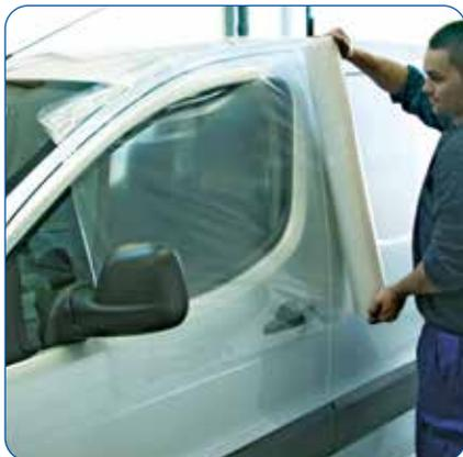
Die Notfallfolie dient als zeitweiser Ersatz für zerstörte Seiten- oder Heckscheiben und erhält so die Mobilität des Fahrzeuges. Die kleine Rolle ist ideal um eine zerstörte ESG-Scheibe zu ersetzen und kann bequem im Fahrzeug mitgeführt werden.
