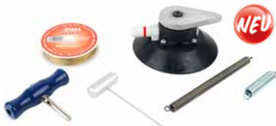
Der große Sauger mit Drehvorrichtung und Rückzugfeder zieht den Draht beim Sägen zurück und übernimmt somit die Rolle der zweiten Person. Sichere und schnelle Befestigung des Saugers durch anpumpen an der Scheibe. Der Draht wird nahe an der Scheibe geführt, was Beschädigungen von Armaturenbrett und Verkleidungen vorbeugt. Geeignet für Sägedraht, nur bedingt für Rund- oder Vierkantdraht.
