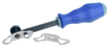
Universell einsetzbares Werkzeug mit zwei Doppelösen, also vier verschiedenen Ösen. Die Wechsellaufsätze sind mit einer Rändelschraube befestigt und können ohne Werkzeug gedreht oder gewechselt werden. Passend für Keder von ca. 6 - 15 mm Breite.
