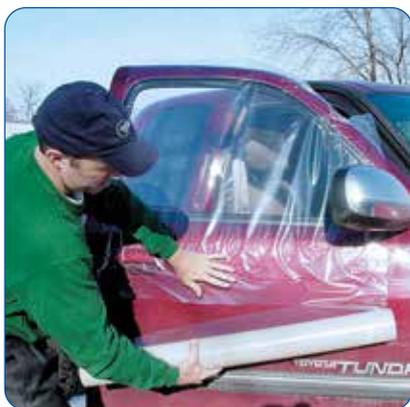
Die Notfallfolie dient als zeitweiser Ersatz für zerstörte Seiten- oder Heckscheiben und erhält so die Mobilität des Fahrzeuges.
