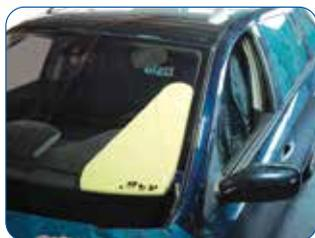
Der Armaturenbrettschutz aus 2 mm starkem Kunststoff ist sehr elastisch und passt sich mühelos allen Wölbungen an. Dabei ist er gleichzeitig besonders widerstandsfähig und hart, damit Schneide- und Sägedrähte leicht darüber gleiten können.
