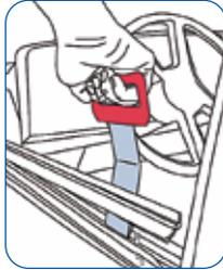
Beim Ausbau von Türschachtdichtungen ist es wichtig, diese nicht zu beschädigen. Dieses Werkzeug gleitet in die Türöffnung und zieht die Abdichtung nach oben heraus, ohne sie zu beschädigen.
