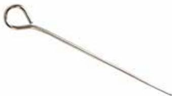
Die Führungsnadeln werden von außen in die PU-Raupe gesteckt um den Draht oder die Schnur in der gewünschten Position zwischen Karosserie und Scheibe zu halten (Motorraum). Dies ist speziell bei überhängenden Windschutzscheiben (Karosserie) nötig.
