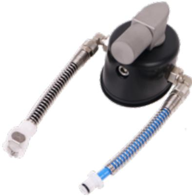
Komplette Reparaturbasis mit Harzkammer und Anschlüssen. Nur in Verbindung mit dem Reparatursystem WSR-800 GECKO (sowie dem WSR-800 der 1. Generation) verwendbar. Die Reparaturbasis wird über den schwarzen Anschluss per Unterdruck an die Scheibe angesaugt. Der blaue Anschluss beaufschlagt die Harzkammer mit Unter- und Überdruck. Falls Sie einen Defekt an Ihrer Basis vermuten oder nur Einzelteile benötigen wenden Sie sich bitte an unseren Vertrieb.
