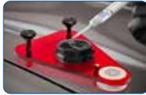
Nivellier-Ebene zur perfekten Ausrichtung der zu befüllenden Sensoren. Durch die Nivellierung der Sensorkörper wird eine zu 100 % gleichmäßige Befüllung erreicht.
