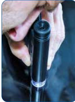
Taschenmikroskop aus Kunststoff mit 40-facher Vergrößerung und LED-Beleuchtung. Als Hilfsmittel zur Reparatur und Beurteilung von Steinschlagschäden und Glaskratzern. Für die LED-Beleuchtung werden zwei 1,5V Mignon-Batterien benötigt (Lieferung ohne Batterien).
