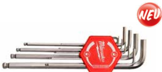
Drehverriegelung zur leichten Entnahme der Schlüssel. Kugelkopf erleichtert den Zugang zu Schrauben und ermöglicht das Arbeiten bei einem Winkel von bis zu 30°. Größenkennzeichnung zur leichten Auswahl des richtigen Schlüssels. Lochung zur leichten Fixierung an einer Milwaukee® Werkzeugsicherung bei Arbeiten in der Höhe.
