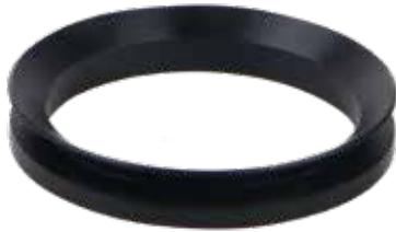
Die V-Dichtung ist für den sicheren Halt der Reparaturbasis auf der Scheibe verantwortlich. Das Material (NBR) weist eine mittlere Resistenz gegen die verwendeten Chemikalien auf. Bei häufigem Kontakt mit Harz kann es jedoch zum Aufquellen kommen. In diesem Fall, und im Falle einer mechanischen Beschädigung, muss die Dichtung ersetzt werden.
