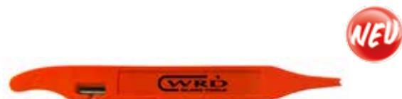
Handliches Verlegewerkzeug für die SPIDER & ORANGE BAT & BISON Austrennsysteme mit zwei unterschiedlich geformten Enden. Die Einkerbung an einem Ende ermöglicht das punktuelle Verlegen der Schnur an schwer zugänglichen Stellen, z. B. an den unteren Ecken vieler Windschutzscheiben. Die Nut in geschwungener Form am anderen Ende eignet sich zum schnellen und einfachen Verlegen der Trennschnur unter Dichtlippen. Mit integrierter Cutterklinge zum Ablängen der Schnur (Klinge nicht austauschbar).
