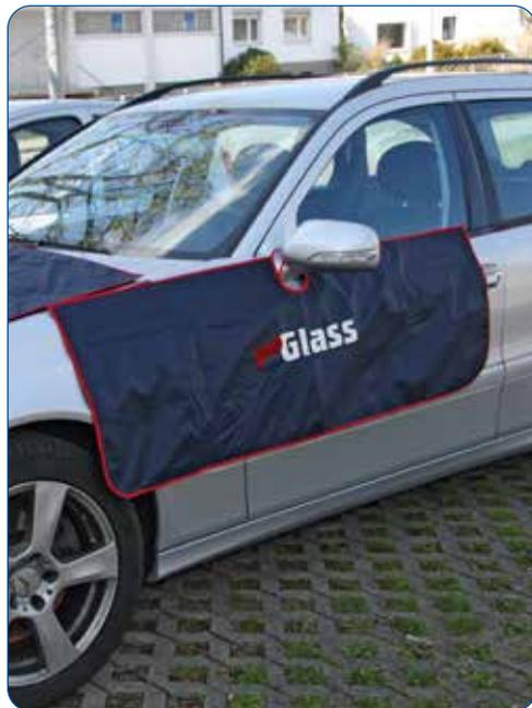
Werkstattschoner für Kotflügel und Türen mit variabler Befestigung. Geeignet für sämtliche magnetischen und nicht magnetischen Karosserien.
