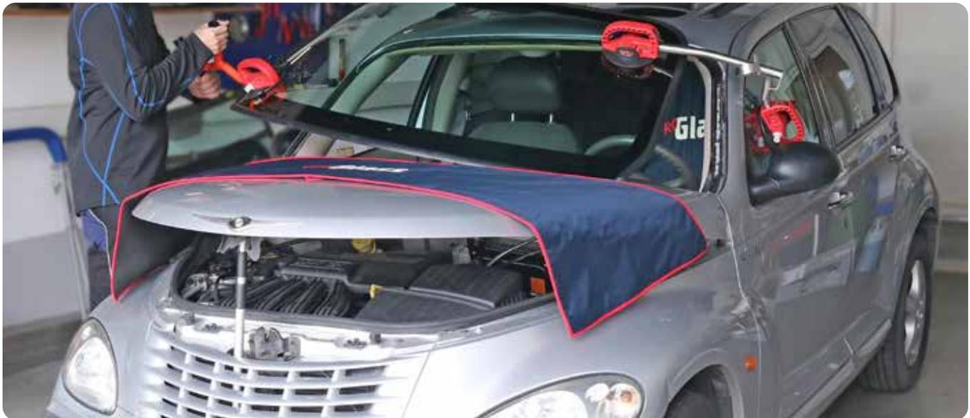
Das Montagesystem aus der PRO6 Serie von WRD Glass Tools ermöglicht das einfache Einsetzen von Windschutzscheiben durch nur eine Person. Das ausgeklügelte System eignet sich für Pkw- und Transporterscheiben und gestattet die Windschutzscheiben-Montage an nahezu sämtlichen Fahrzeugmodellen. Dies beinhaltet auch stark gewölbte oder von Karosserieteilen überdeckte Scheiben.
